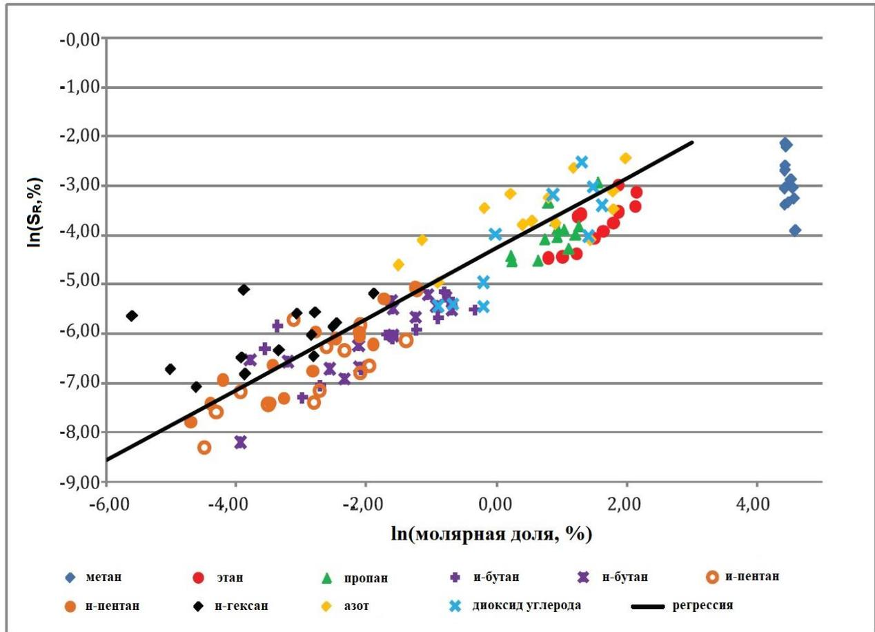
Рисунок А.2 – Логарифм стандартного отклонения воспроизводимости как функция  $\ln(X, \%)$  для неметановых компонентов
